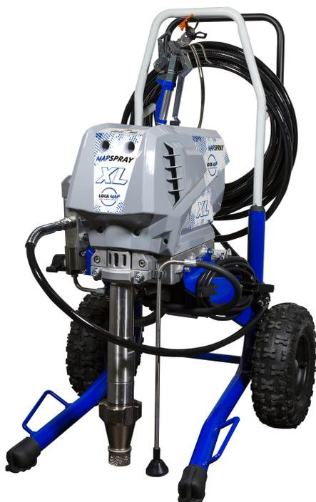
Pulvérisateur sans air puissant et ergonomique conçu pour l'application de peintures et enduits pelliculaires prêts-à-l'emploi sur chantiers de grande taille.
