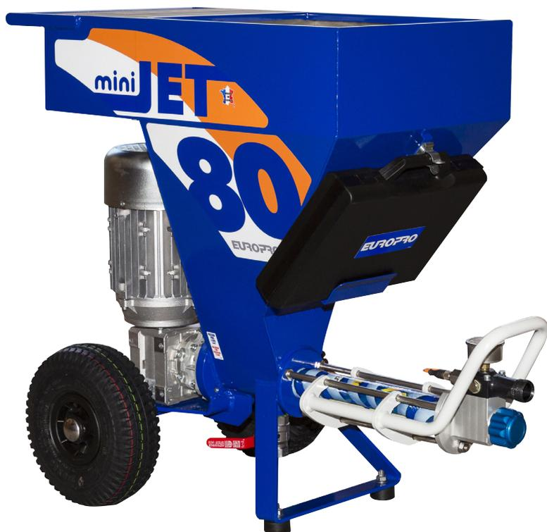
La MINIJET 80 permet d'appliquer tout type d'enduit pelliculaire en pâte. C'est une machine compacte, silencieuse et légère qui passe partout.
