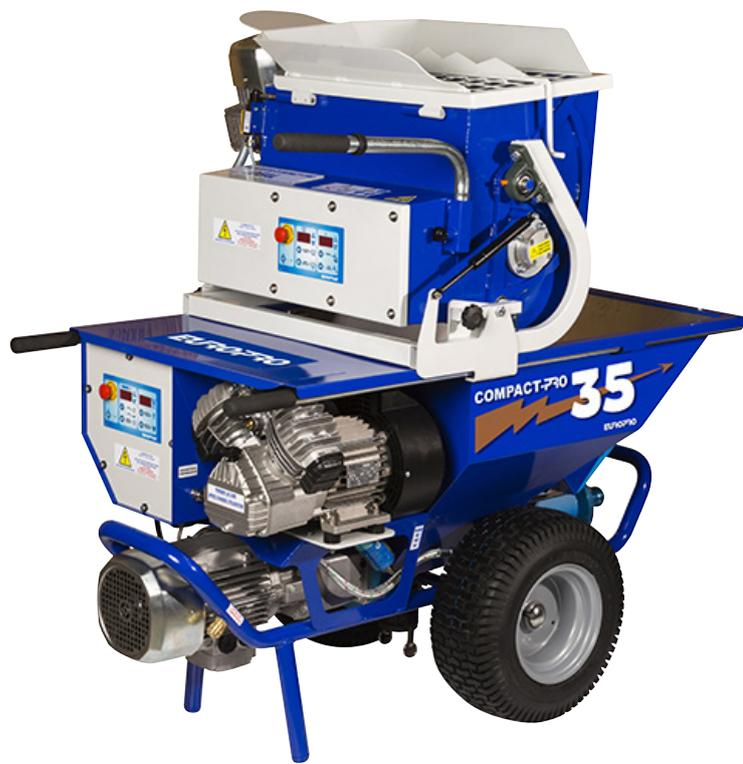
Ensemble composé d'une machine à projeter et d'un malaxeur séquentiel.
